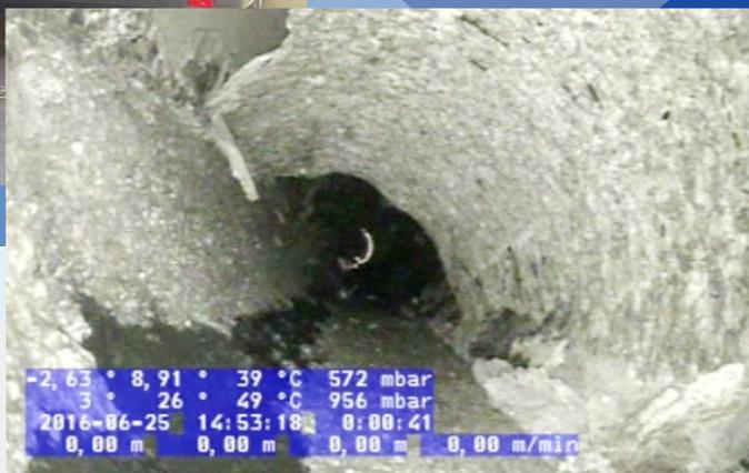
Модульная телеинспекционная система ROVION (компания iPEK) - используется для видеодиагностики состояния канализационных труб диаметром от 100 до 2000 мм.
